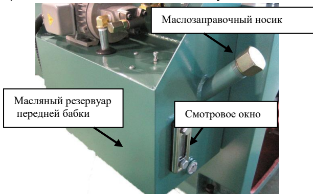
Рис. 70 Масляный резервуар передней бабки и его элементы.
