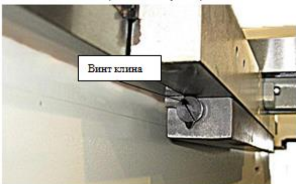
Рис. 90. Один из двух винтов заднего клина салазок.
