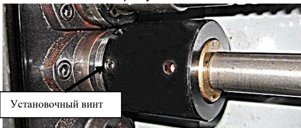
Рис. 95. Удаление установочного винта из ободка муфты.
