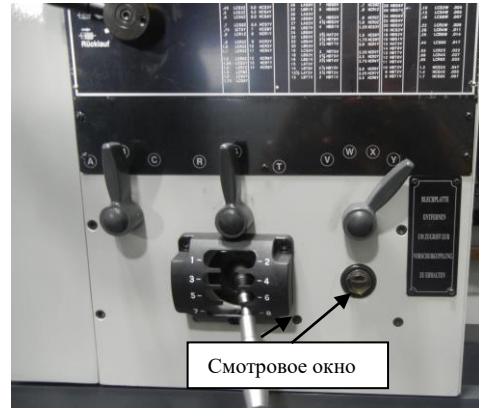
Рис. 74. Расположение смотрового окна коробки скоростей.
