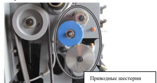
Рис. 83. Расположение приводных шестерен, которым требуется смазка.
