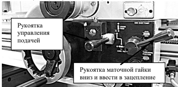
Рис. 54. Установка элементов управления кареткой для нарезания резьбы
