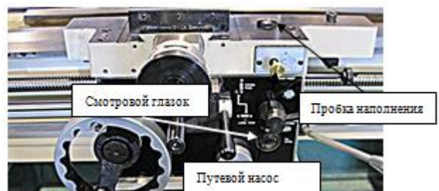
Рис. 79. Расположение насоса направляющих, пробки наполнения и смотрового окна салазок.
