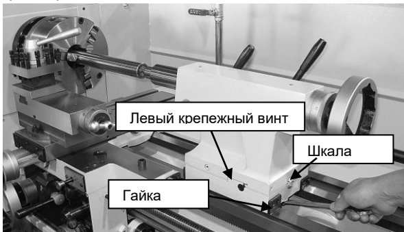
Рис. 35. Регулировка смещения задней бабки.
