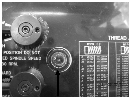
Рис.23. Смотровое окно масляного насоса.
