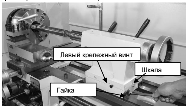
Рис. 35. Регулировка смещения задней бабки.
