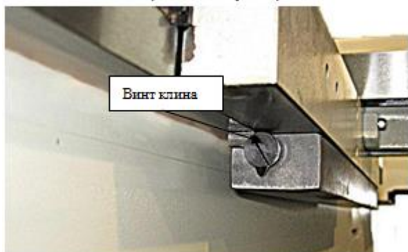
Рис. 90. Один из двух винтов заднего клина салазок.
