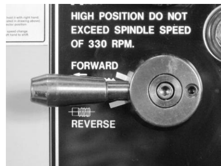
Рис. 18. Рукоятка выбора направления подачи Вперед (Forward)/Назад (Reverse)
