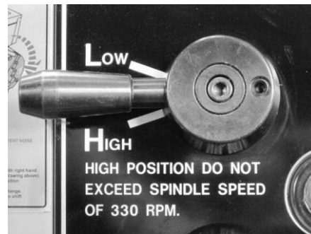
Рис. 24. Рукоятка переключения диапазонов коробки скоростей
