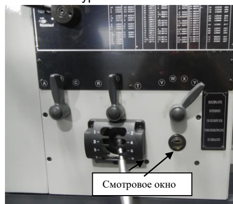
Рис. 74. Расположение смотрового окна коробки скоростей.
