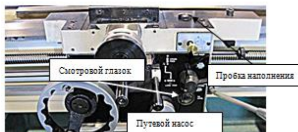
Рис. 79. Расположение насоса направляющих, пробки наполнения и смотрового окна салазок.
