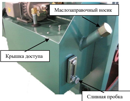
Рис. 72. Расположение элементов масляного резервуара передней бабки.
