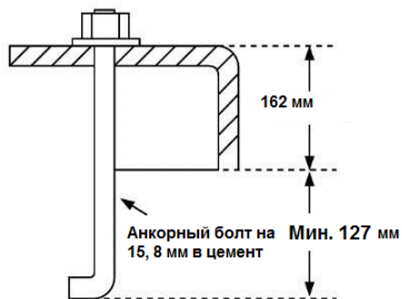
Схема крепления основания анкерными болтами
